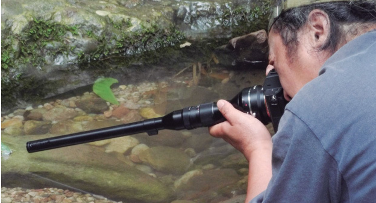
Parece um cano de espingarda, mas é a estranha lente Laowa 24 mm f/14 Macro Probe, que consegue foco a apenas 20 mm
