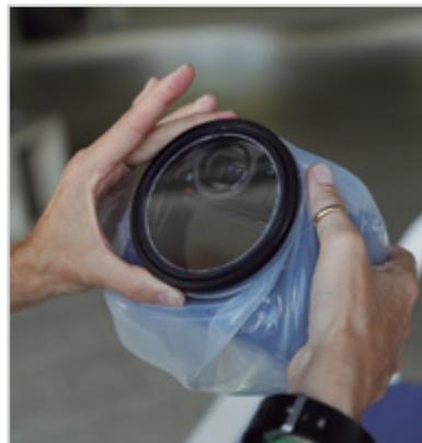
**3** Usando a própria borracha da capa como vedação, é rosqueada a janela de monitor. O adaptador óptico deve ser inserido nesta etapa.
