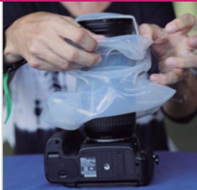
**1** A capa é colocada na câmera por meio da abertura redonda na traseira. É preciso esticar bem a abertura para o processo.
