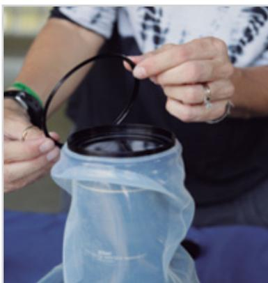
**5** Um anel *o-ring* de metal é colocado para garantir a vedação e depois é colocado um segundo filtro para finalizar o processo.
