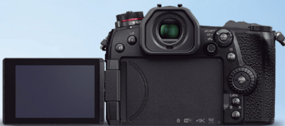
Monitor articulado, útil para gravação de vídeos (à esq.); entrada para dois cartões de memória SD/SDHC/SDXC UHS-II (à dir.)
