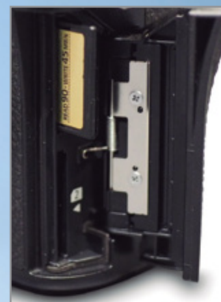
Monitor articulado, útil para gravação de vídeos (à esq.); entrada para dois cartões de memória SD/SDHC/SDXC UHS-II (à dir.)
